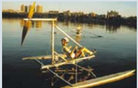
«Deacaviator», Prototyp des Rekord-Tragflächenboots gebaut am Massachusetts Institut of Technology, 1989
