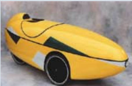
«Quest», aerodynamisches Dreirad mit Glasfaser Epoxid/Polyster-Karosserie, Serienfahrzeug aus den NL
