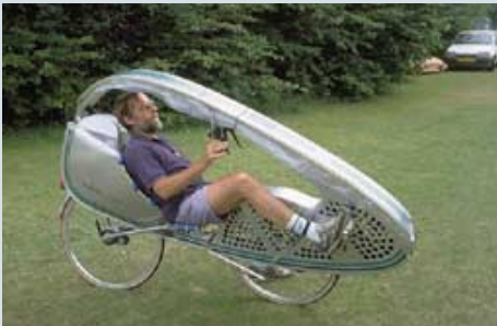
Eigenbau nach dem Flevo-Knicklenker-Prinzip aus den Niederlanden
